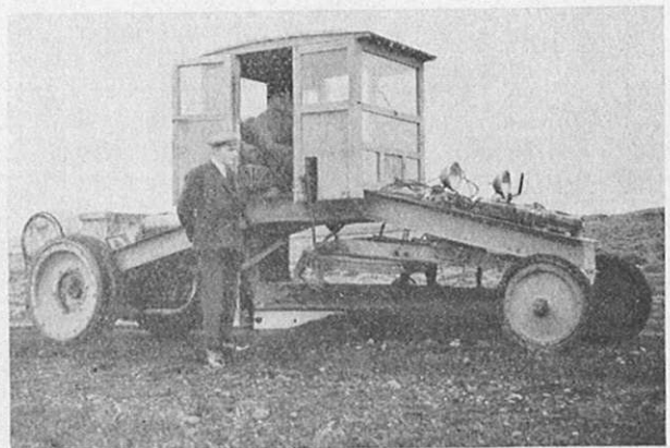
Drafn veihøvl med førerhus på Island. 4 vinduer i frontveggen.
